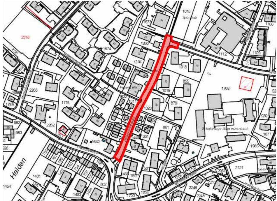
Die Zielackerstrasse weist vollflächig einen schlechten Zustand auf: Die Beläge sind durchzogen von Netzrissen, die Randabschlüsse teils stark verwittert. Zudem ist der Querschnitt für die heutige Funktion als Erschliessungsstrasse überdimensioniert.
